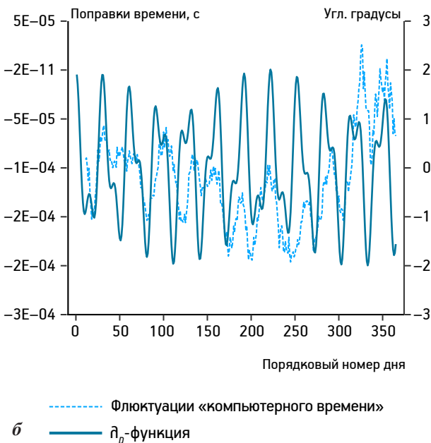
Рис. 6. Сравнение хода поправок (9 pt. mov. aver.) GPS в компьютере на ст. Восток (Антарктида) с \lambda_D -функцией за период с 01.02.1998 по 01.02.1999 г.
